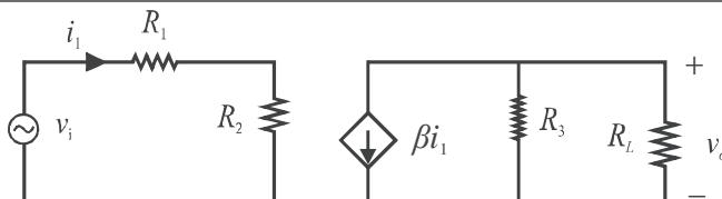
O diagrama acima representa um modelo simplificado, adequado à análise de pequenos sinais, de um amplificador eletrônico cuja carga é representada pela resistência  $R_L$ . Considerando esse modelo e que o parâmetro  $\beta$  é positivo, julgue os itens seguintes.
