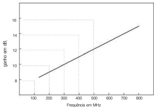
Os gráficos acima mostram o coeficiente de onda estacionária e o ganho (em dB), em função da frequência, na direção de máxima radiação, de uma antena projetada para operar em espaço livre e ser alimentada por uma linha coaxial de 50 ohms. Considerando que essas informações sejam válidas tanto para transmissão quanto para recepção, julgue os próximos itens.
