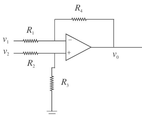
O diagrama acima representa um circuito que contém um amplificador operacional. As tensões elétricas de  $v_1$ ,  $v_2$  e  $v_o$  são a diferença de potencial entre o ponto a que a tensão está associada e o fio terra. A respeito desse circuito, considerando que o amplificador em questão é ideal, julgue os itens a seguir.
