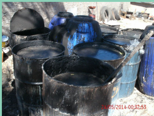
Armazenamento irregular de massa asfáltica
