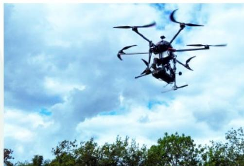
Multirrotores com termógrafo.
