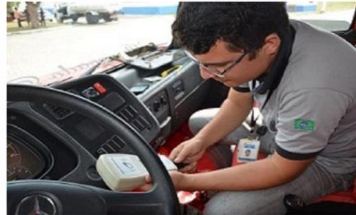
**Instalação nos veículos do Módulo Embarcado de Monitoramento (MEM)**
