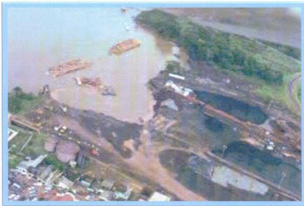
Figura 09: Foto aérea mostrando o deslizamento no porto da mineradora Anglo Ferrous, em Santana-AP. Notar a geometria circular da ruptura, em duas frentes. (fonte web)
