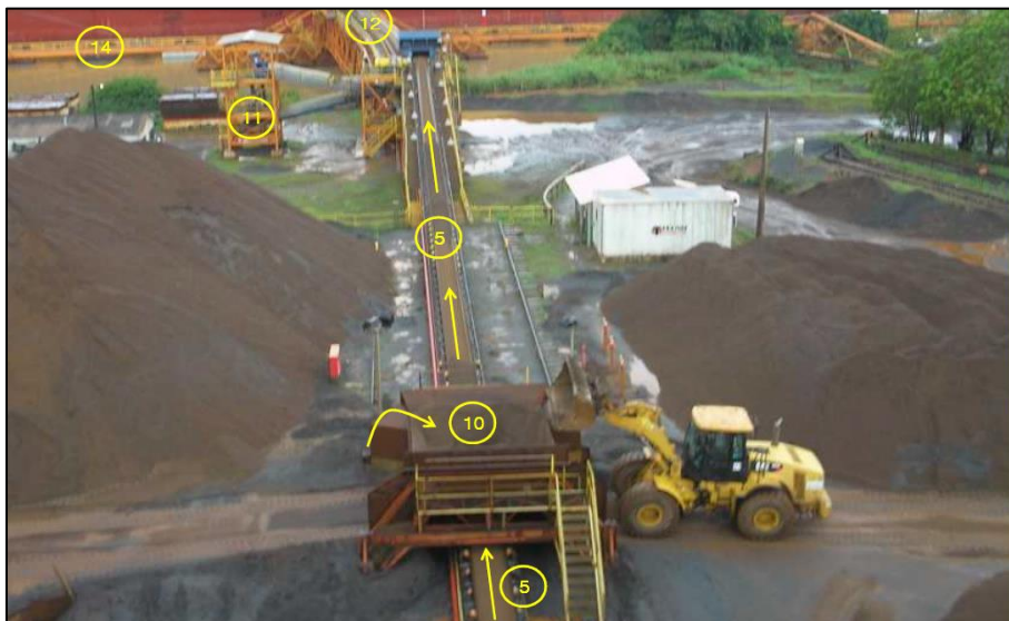
Figura 82 – Carregamento direto da moega central (10), em foto retirada do Memorial Descritivo GGL da Anglo American, com data de abril de 2011.
