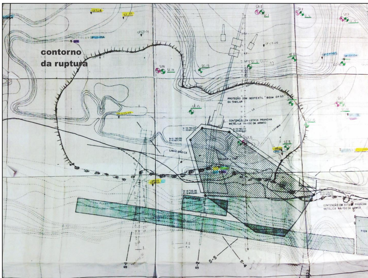
Figura 13. Limites do escorregamento (batimetria de 1993, Relatório 01) e localização das investigações geotécnicas consideradas no presente Parecer.
