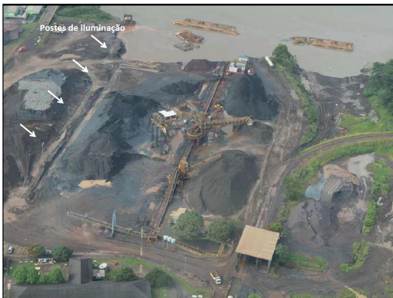
Figura 26. Cenário pós-ruptura, revelando movimentação indiscriminada de pilhas de minério em local não autorizado em projeto nas seções Leste e Oeste.
