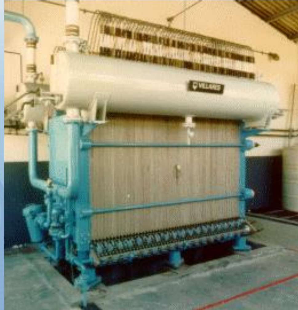
Eletrolisador VILLARES/BAMAG alcalino bipolar 100 m 3 /h
