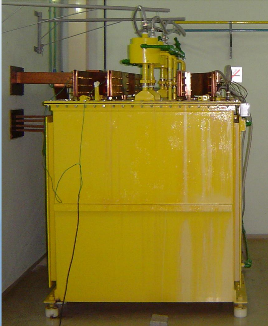
Eletrolisador UNICAMP/CEMIG alcalino unipolar 5 m 3 /h
