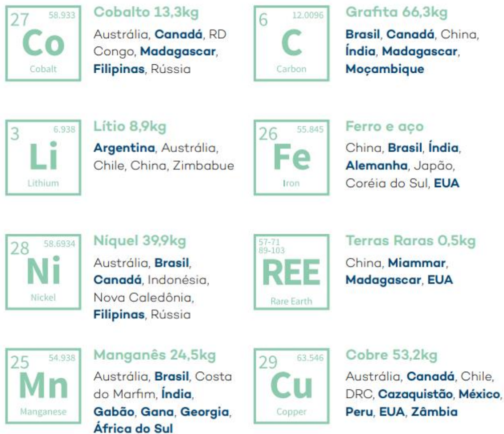
Figura 5: Minerais e metais para veículos elétricos por peso (em kg) e principais países produtores.
