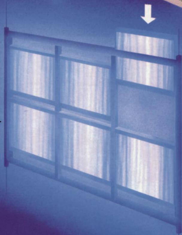
Esquema fornecido pela MDS Nordion (Canadá), mostrando uma montagem típica de uma grade de fontes (*source rack*) de um irradiator industrial. Desde os peletes (*slugs*), passando pelos lápis (*pencils*), módulos (*module*) até chegar à montagem final [IAEA, 2004].
