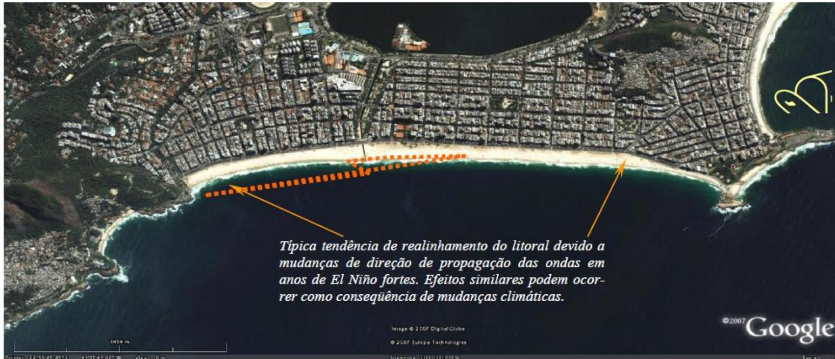
Figura 4: Exemplo de arco de praia em zona urbana – praia do Arpoador-Ipanema-Leblon. Destaca-se a típica tendência de realinhamento do litoral devido a mudanças de direção de propagação das ondas em anos de El Niño forte. Efeitos similares podem ocorrer como consequência de mudanças climáticas.
