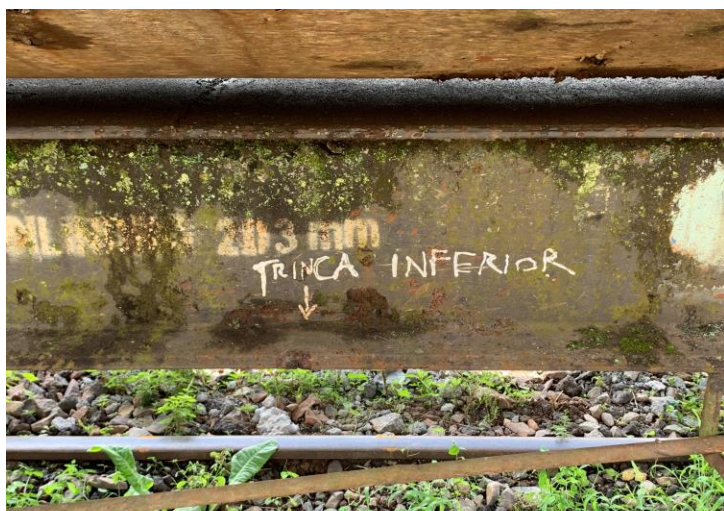
Trinca na viga principal Vagão com 56 anos
