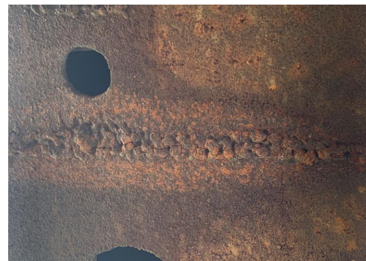
Trinca na travessa principal Vagão com 62 anos
