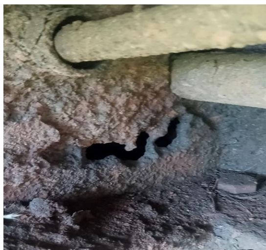
Corrosão generalizada Vagão com 58 anos
