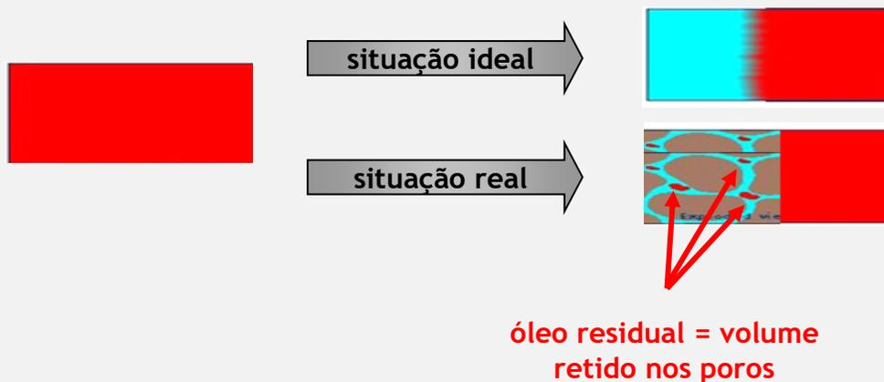
Petróleo sendo deslocado pelo gás miscível após injeção de água
