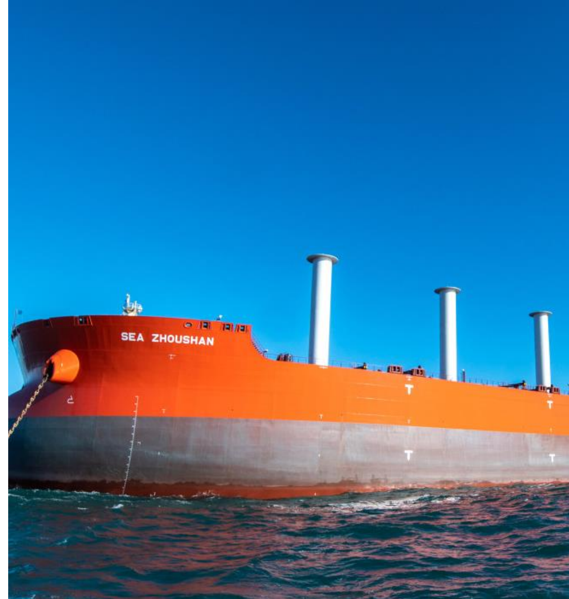
Foto: Primeiro navio do mundo equipado com rotor sails Vitória, ES, Brasil
