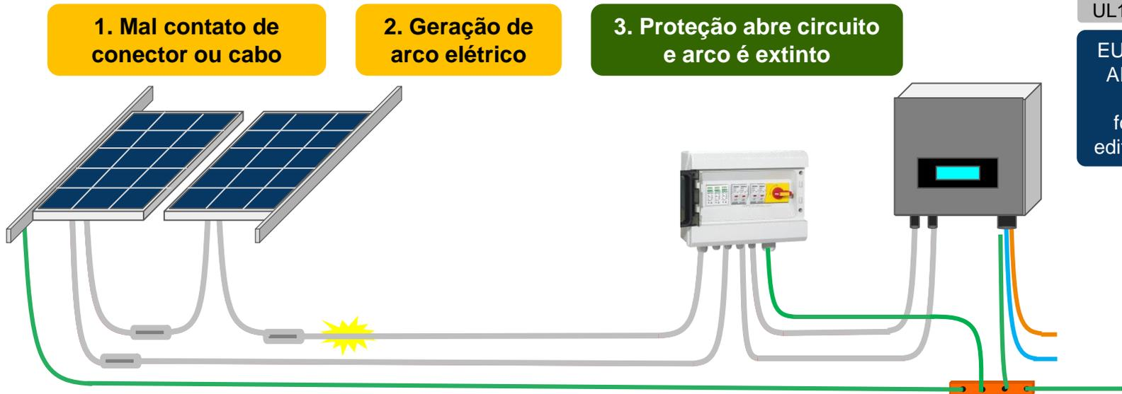
OBS.: AFCI instalado junto ao inversor protege contra arcos elétricos em todo o circuito c.c.
