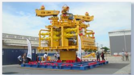
Sistema de bloqueio de poço no Brasil (Capping)
