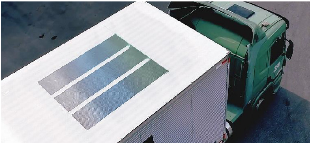
Módulos solares fotovoltaicos em caminhões de carga, Campinas (SP).
