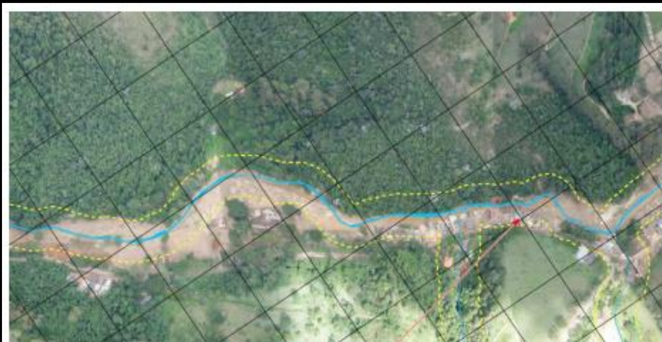
Figura 47: Foto aérea (26.01.2011) onde podem ser observados os efeitos da inundaç o sobre as habita es localizadas na margem do rio. A maioria das edifica es afetadas encontra-se total ou parcialmente dentro da faixa de APP de 30 metros. Nota-se tamb m que na margem oposta, no trecho onde a vegeta o estava preservada os efeitos da inunda o s o menores, e, o que   mais importante, n o houve preju zos socioecon micos e perda de vidas.
