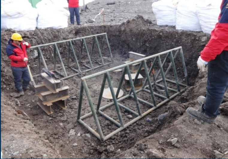
Montagem da estrutura de apoio para os ensaios Plate Load Test (PLT).
