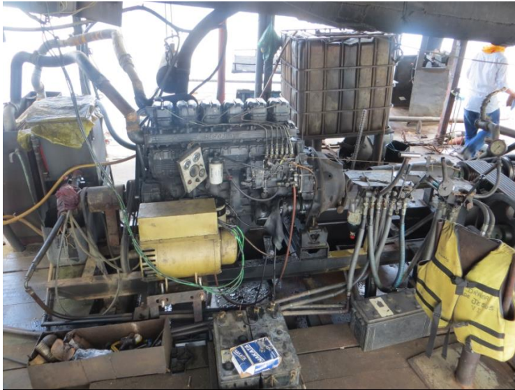
Figura I- trabalhador sem EPI's exposto a riscos. Máquinas sem proteção, fiação elétrica exposta.
