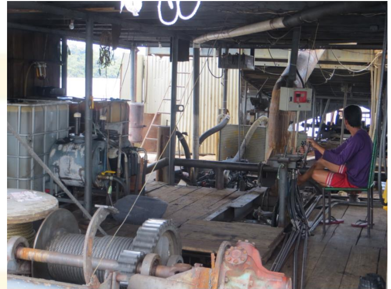
Figura I- trabalhador sem EPI's exposto a riscos. Máquinas sem proteção, fiação elétrica exposta.
