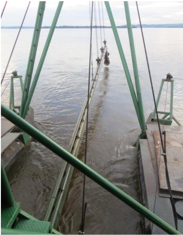
Figura12- “Lança controlada por guinchos mecânicos” que varre o fundo do rio e na extremidade um escarificador.
