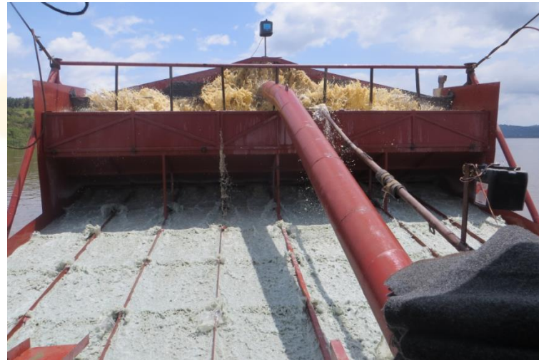
Foto 11- caixa concentradora de minério acarpetada.
