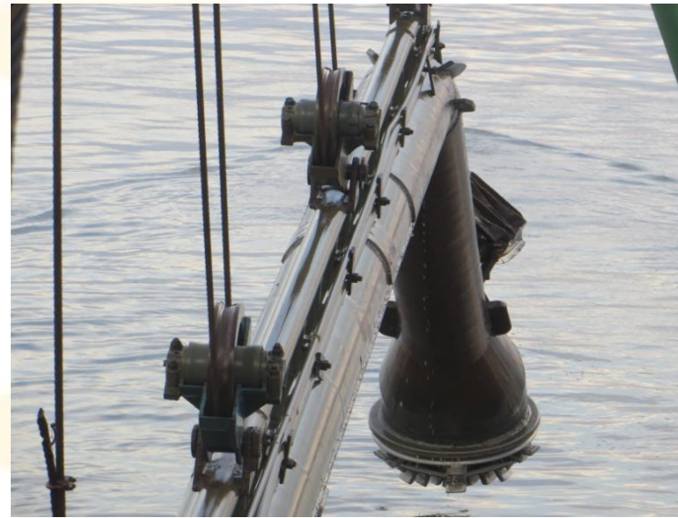
Figura12- “Lança controlada por guinchos mecânicos” que varre o fundo do rio e na extremidade um escarificador.
