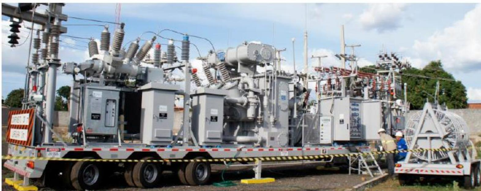
**Este moderno equipamento permite um rápido reestabelecimento de energia em caso de problemas com os transformadores de potência instalados nas subestações**
