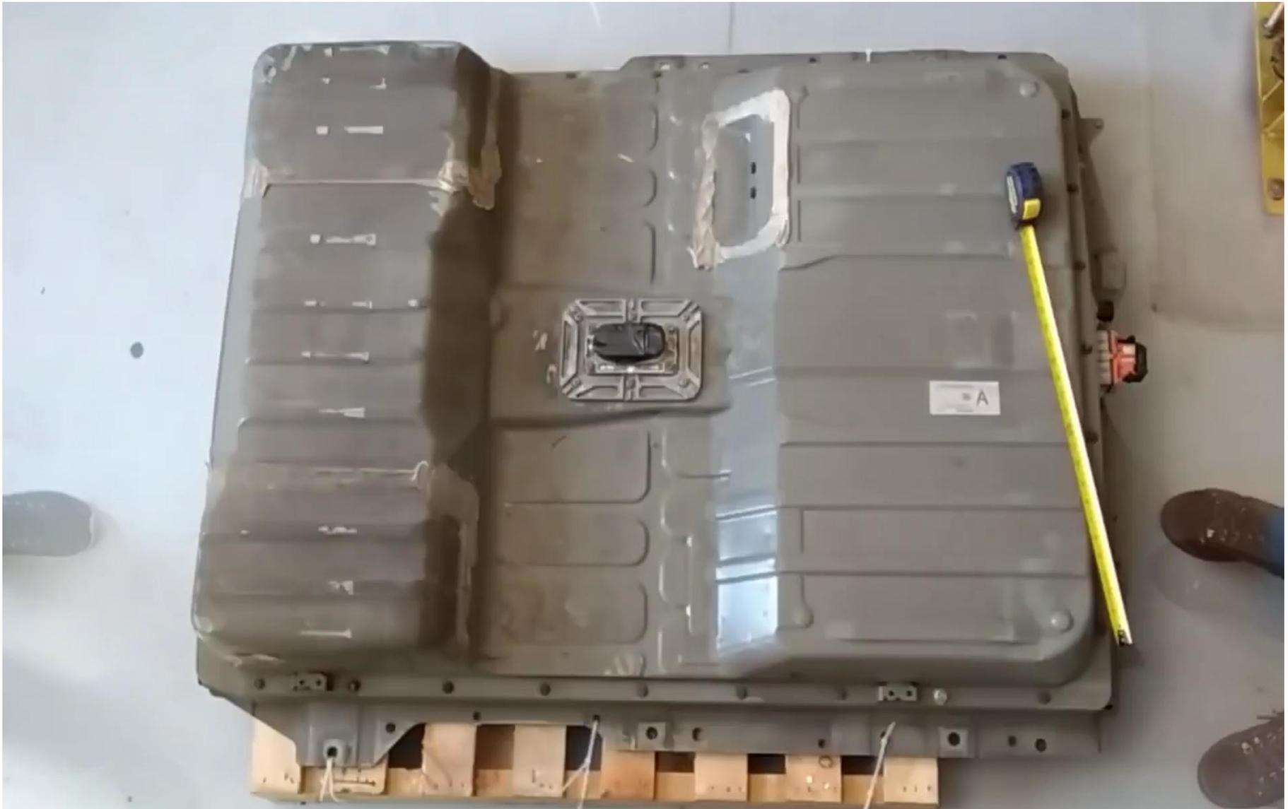
Bateria de Li-ion de 25 kWh de veículo Nissan Leaf em processo de reconfiguração para uso em aplicações estacionárias de segunda-vida no laboratório Fotovoltaica/UFSC
