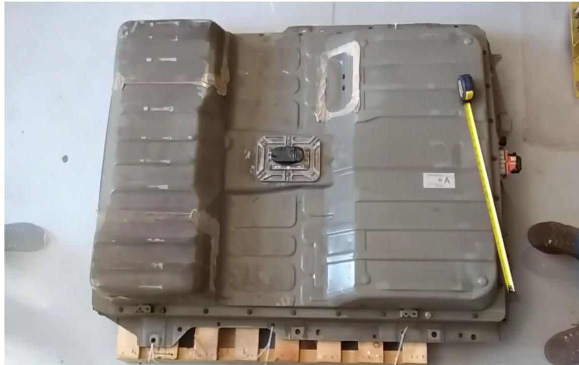
Bateria de Li-ion de 25 kWh de veículo Nissan Leaf em processo de reconfiguração para segunda-vida no laboratório Fotovoltaica/UFSC
