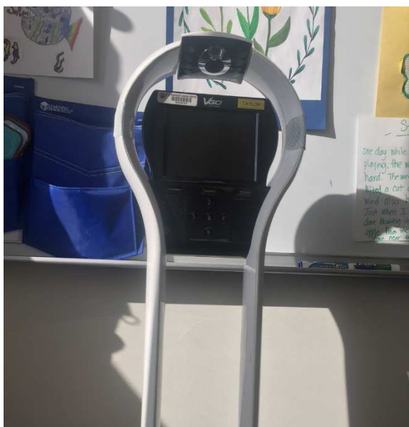
Foto 7: Robô que é levado até a escola do aluno internado para que ele interaja com sua turma ao vivo, através do tablet que está acoplado na parte de cima.
