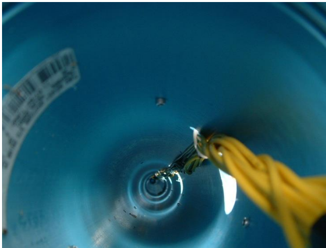
Figuras 1 e 2. Revestimento e vista interna dos poços multi-eletrodos.
