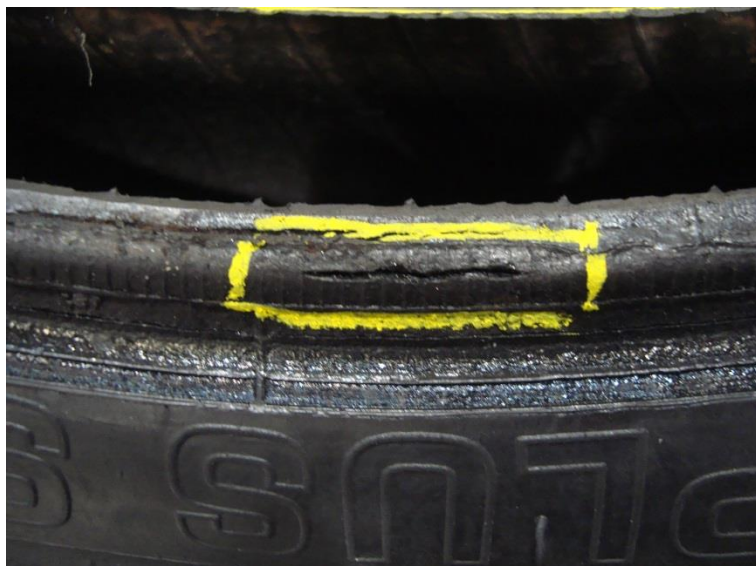
Figura 10 Defeito externo, rachaduras na superfície externa do talão
