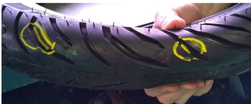
Figura 31: Modo falha da banda de rodagem, por rachadura da banda, apresentado pela amostra 6 marca E
