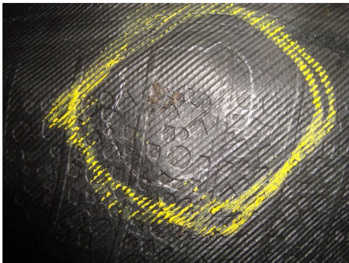
Figura 13: Defeito interno, fio (cordone) exposto na superfície interna da 1ª lona da carcaça
