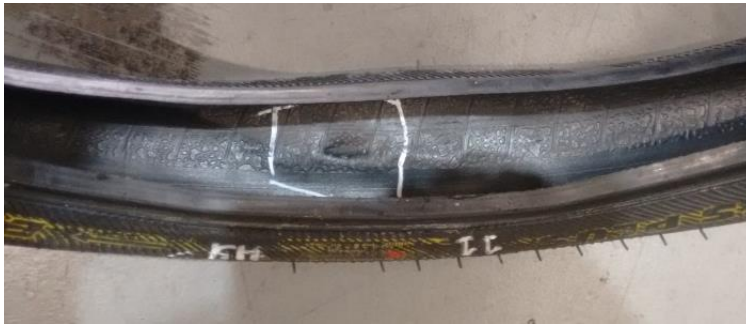
Figura 27: falha da carcaça, por bolha interna da marca A
