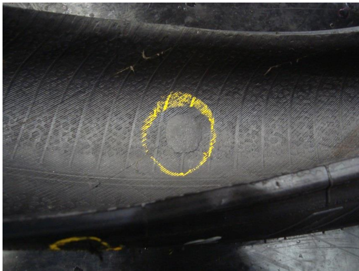
Figura 12: Defeito interno, conserto interno na carcaça na direção da banda de rodagem
