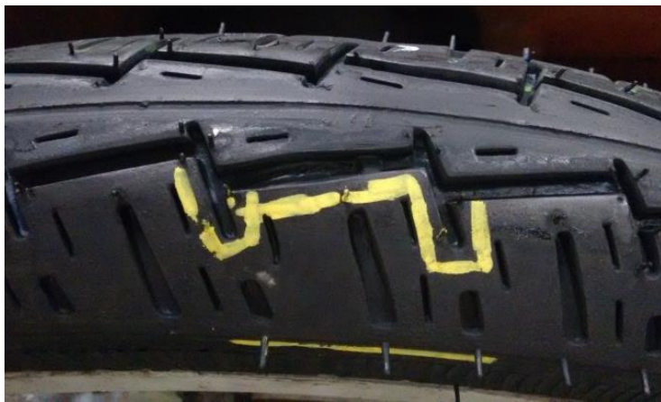
Figura 24 Modo de falha da banda de rodagem, por rachadura da banda da amostra 11 da marca A
