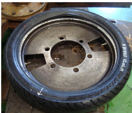
Figura 19: Destalonamento, com deformação plástica do talão, sem rompimento dos fios
