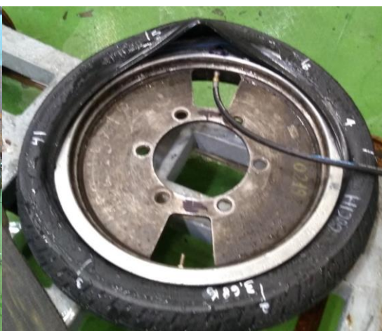
Figura 20: Destalonamento, com deformação plástica do talão, com rompimento dos fios
