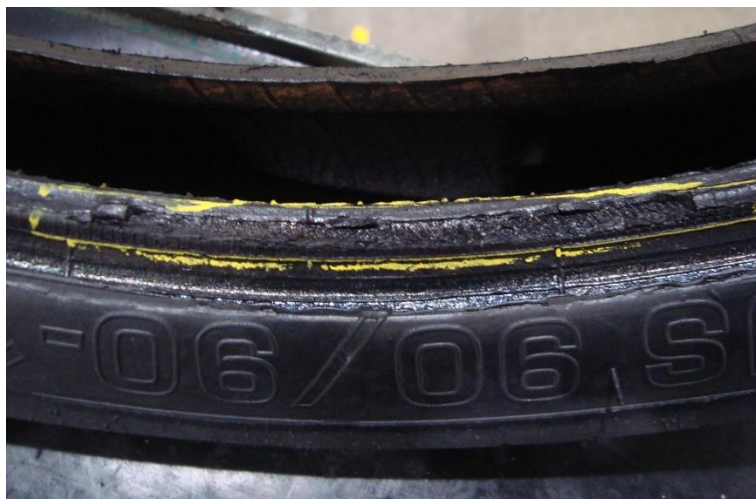
Figura 7: defeito externo, falta de material na superfície externa do talão
