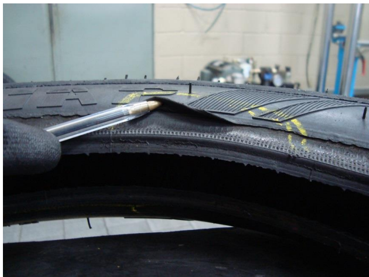
Figura 5: Defeito externo, descolamentos na região da junção entre o flanco e o talão.
