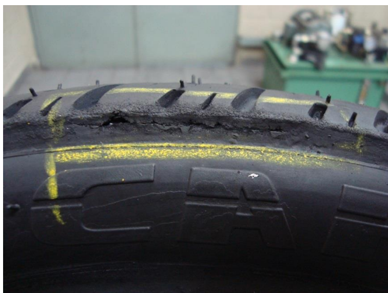
Figura 6: Defeito externo, falta de material na região da junção entre o flanco e a banda de rodagem (ombro)
