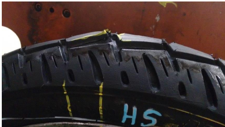
Figura 32: Modo falha da banda de rodagem, por rachadura da banda, apresentado pela amostra 3 Marca B
