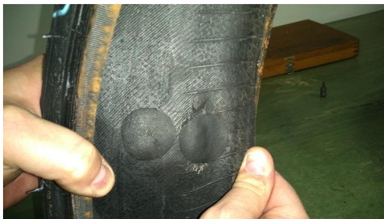
Figura 35: Modo falha da carcaça, por ruptura e exposição dos cordonéis (fios) sob o reparo da carcaça, apresentado pela amostra 12 Marca D.
