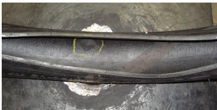
Figura 11: Defeito interno, conserto interno na carcaça na direção do flanco
