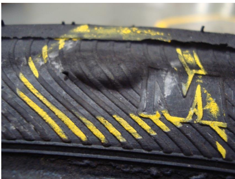
Figura 2: Defeito externo, bolhas no flanco
