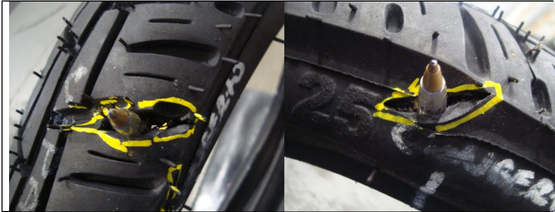
Figura 23: Modo falha por rompimento total da carcaça na direção da banda de rodagem e o flanco
