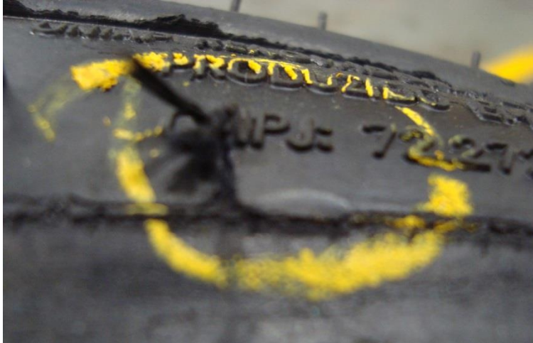
Figura 3: Defeito externo, fio (cordone) exposto no flanco
