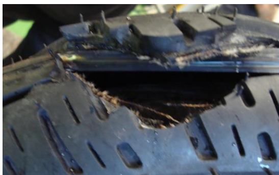
Figura 21: Modo falha da carcaça, por rompimento total na direção da banda de rodagem
