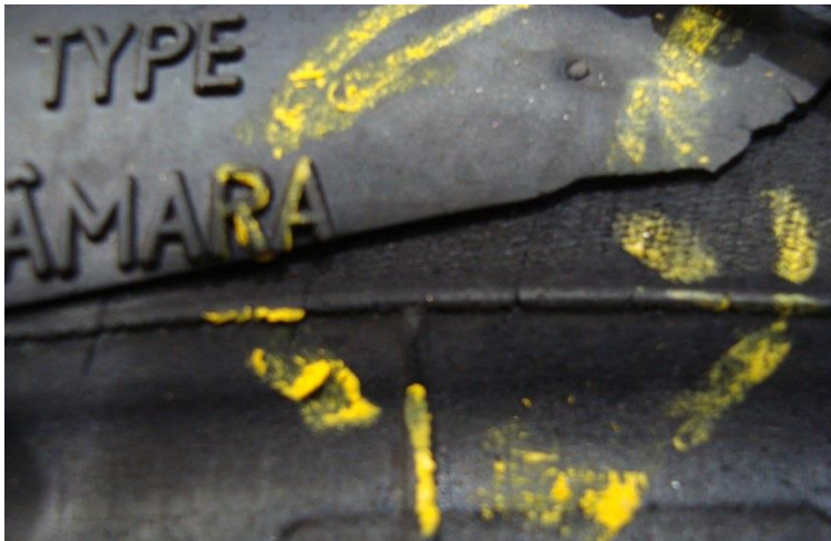
Figura 1: Defeito externo, falta de material no flanco
