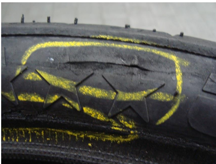
Figura 4: Defeito externo, corte superficial (laceração) no flanco.
