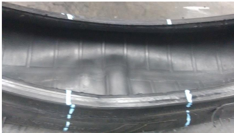
Figura 34 Modo falha da carcaça, por bolha interna na direção da banda de rodagem, apresentado pela amostra 9 Marca F
