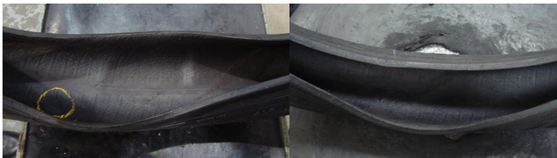
Figura 8: Exemplos de defeito externo, deformação plástica do talão, por tração
