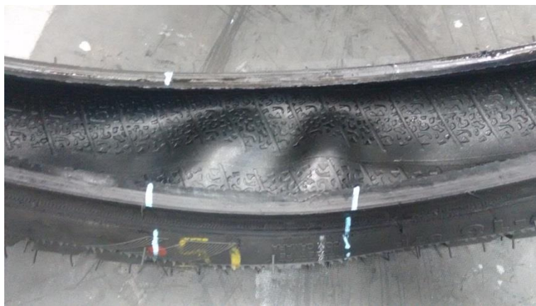
Figura 33: Modo falha da carcaça, por bolha interna na direção da banda de rodagem, apresentado pela amostra 8 Marca F
