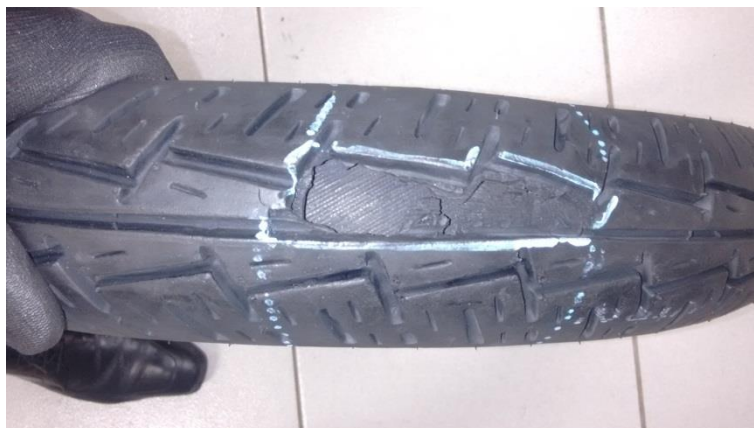
Figura 29: Modo falha da banda de rodagem, por arrancamento da banda com exposição da carcaça, apresentado pela amostra 6 marca C
