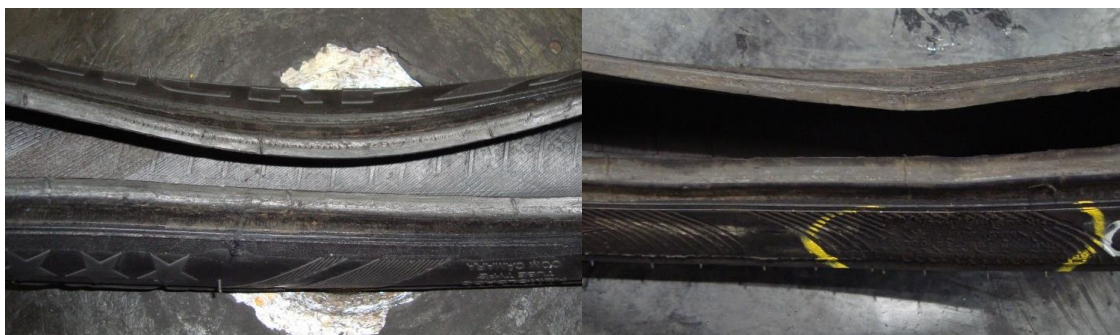
Figura 9: Exemplos de defeito externo, deformação plástica do talão, por compressão
