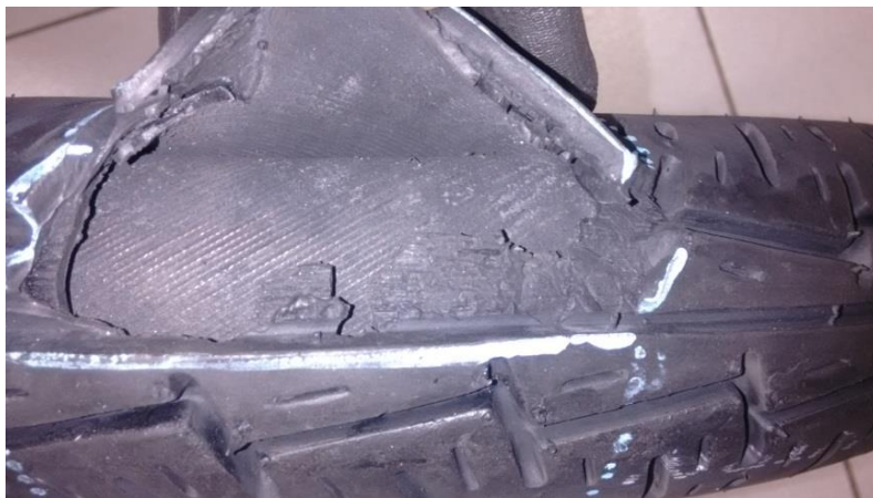
Figura 30: Modo falha da banda de rodagem, por descolamento entre a banda e a carcaça, apresentado pela amostra 6 marca C.
