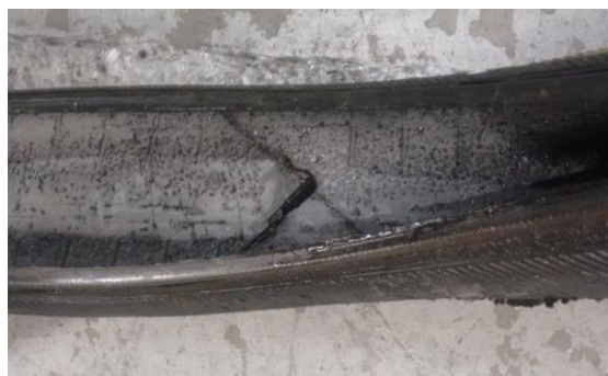
Figura 22: Modo falha da carcaça, por rompimento total na direção da banda de rodagem
