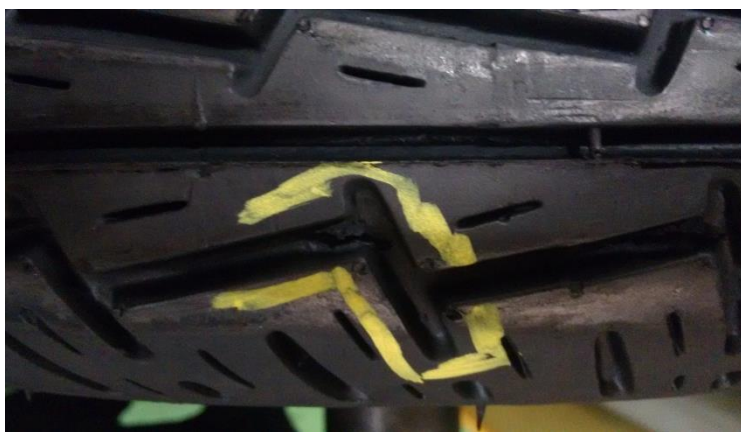
Figura 25 Modo de falha da banda de rodagem, por rachadura da banda da amostra 12 da marca B
