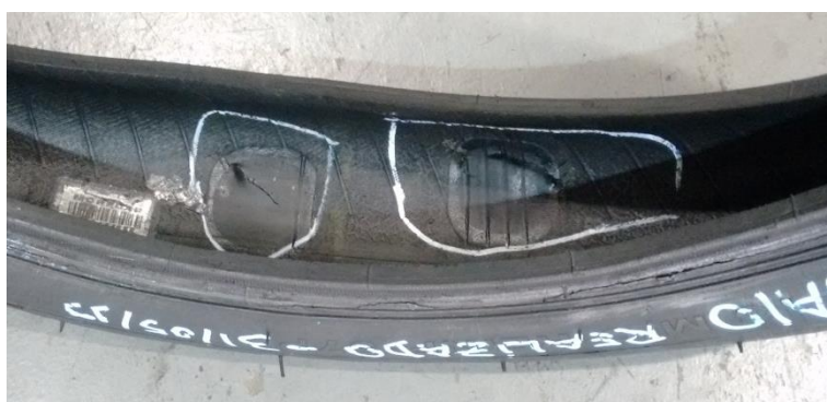
Figura 26: falha da carcaça, por ruptura total da carcaça sob o reparo da marca A.
