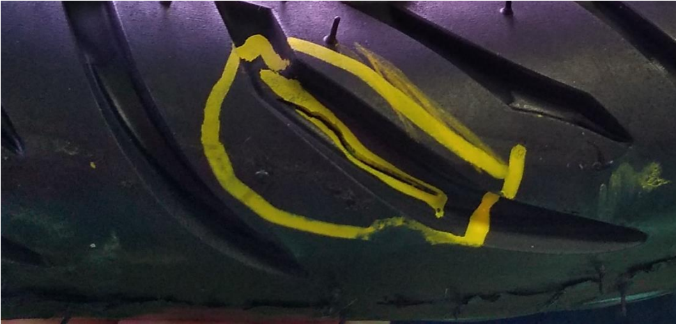
Pneus novos: Rachadura na banda
