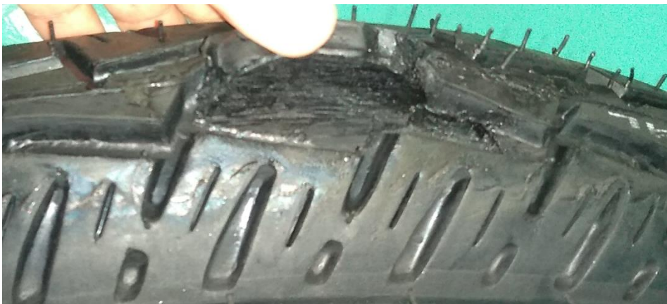
Pneus Reformados: Rachaduras com separação entre a banda com a carcaça
