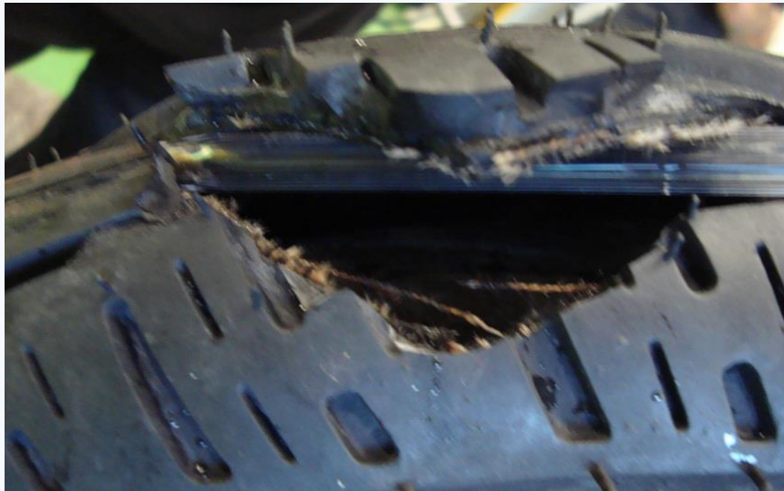
Falha na carcaça de um pneu reformado, ocorrida durante ensaio hidrostático.
