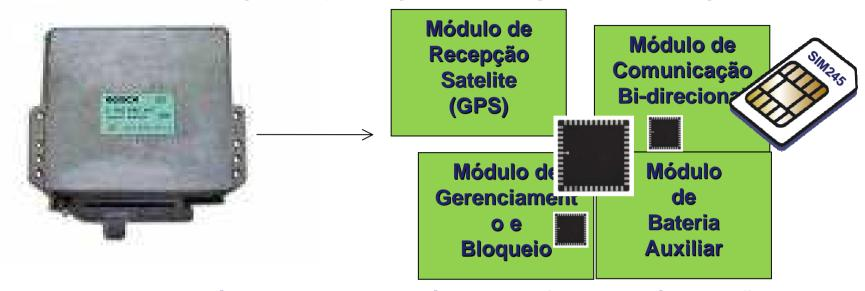
✓O equipamento antifurto é produzido em uma única peça (todo os módulos são controlados e gerenciados por um único processador) com funções de bloqueio e rastreamento completamente separadas e com garantia de ativação somente quando expressamente autorizado.
