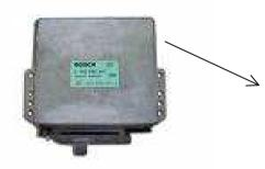
O equipamento antifurto sai de fabrica sem configuração de prestadores de serviços. Esta configuração só pode ser feita com a presença de uma operadora de telefonia celular e de uma chave de acesso que tem que ser solicitada ao DENATRAN. O fabricante do equipamento não conhece em que veículo o seu equipamento foi instalado.
