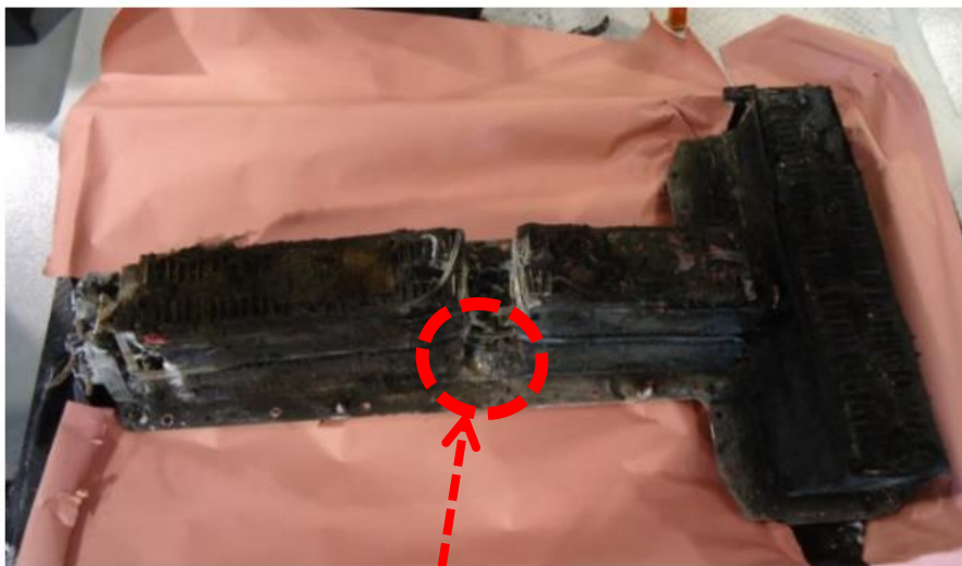
Área do dano em razão do teste de colisão
