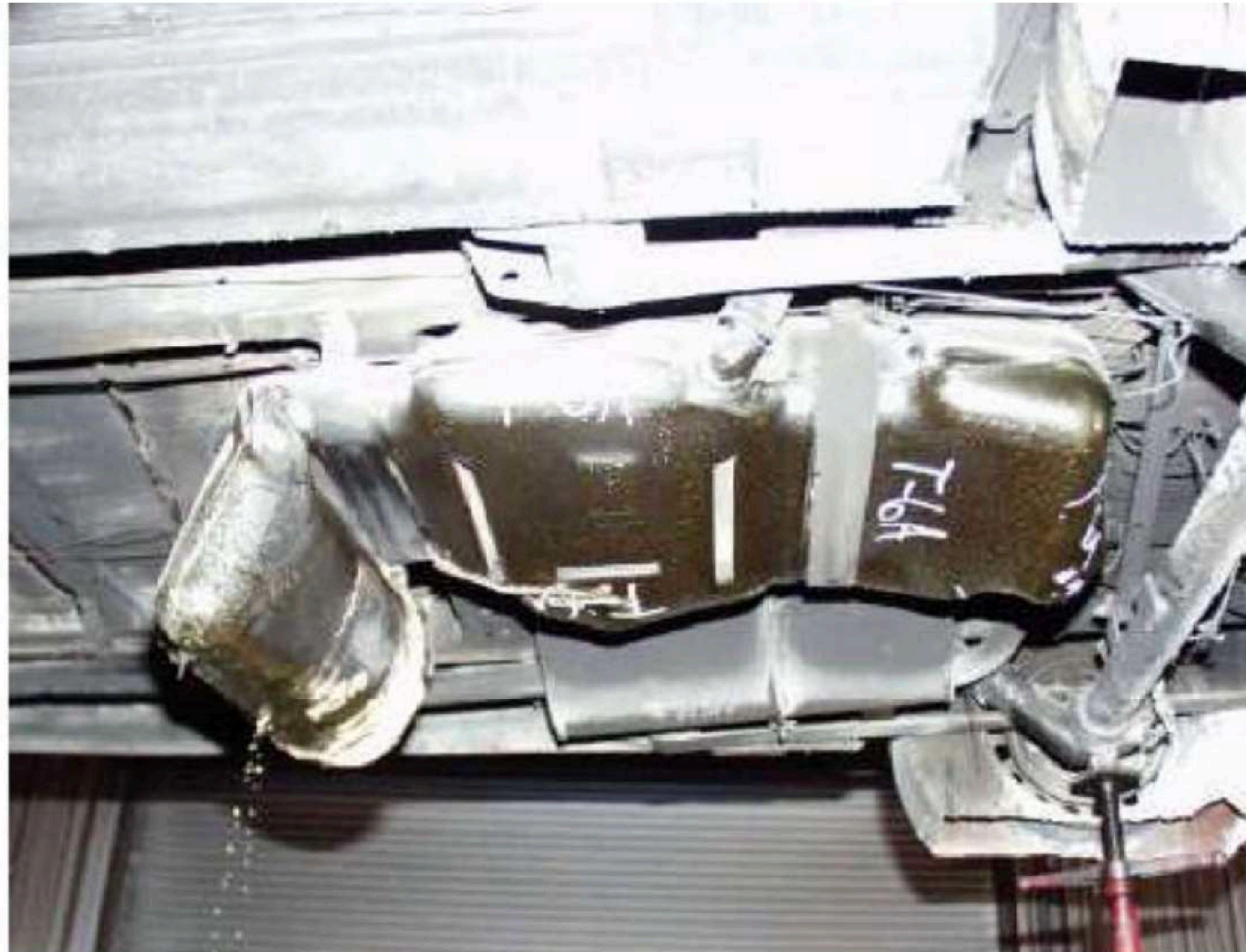
Figura 10 – Tanque de combustível de plástico comprometido [Digges, 2003].
