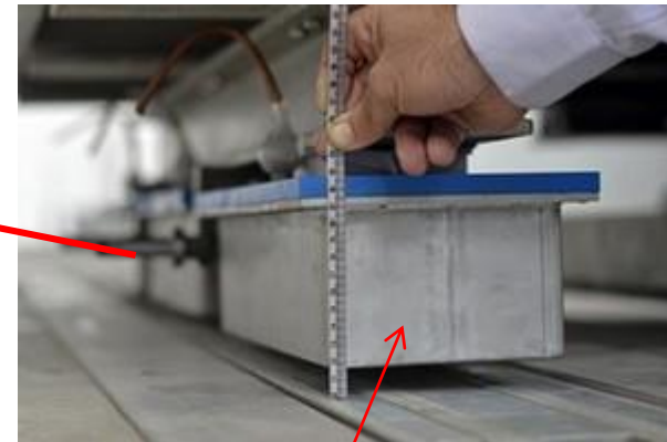
Supercondutores refrigerados por LN 2 no interior de criostatos
