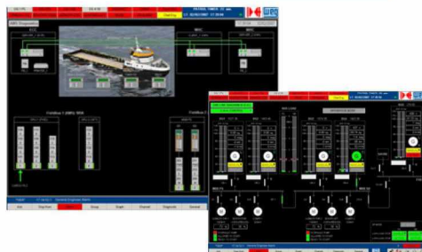
Sistema de Automação (Cargo, AMS, PMS)
