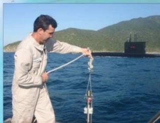
Lançamento de equipamento CTD (Condutividade, temperatura e profundidade). Equipamento utilizado para se obter o perfil de velocidade do som
