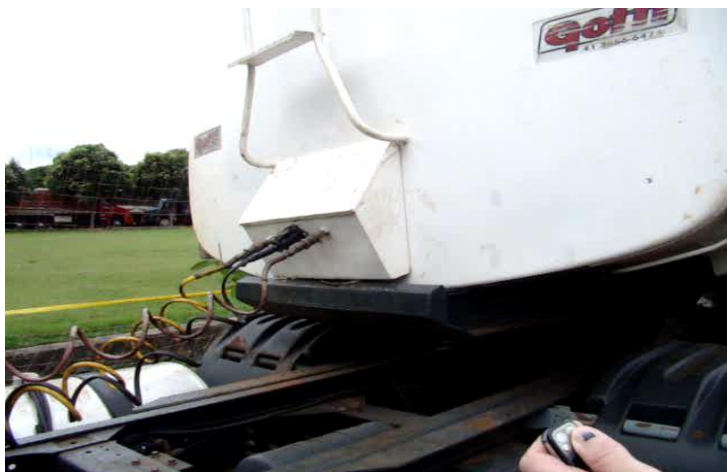
Abertura do fundo falso com acionamento do alarme
