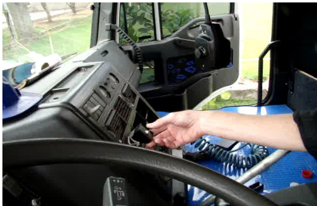
Dispositivo no painel que aciona botões na dianteira da carreta
