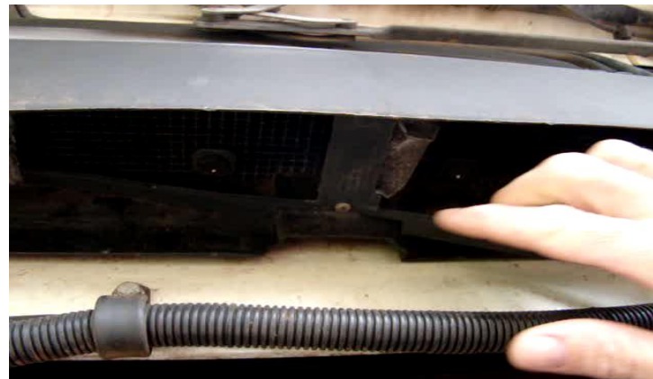
Botão escondido no filtro de ar que conjuga o mecanismo de abertura do fundo falso ao sistema de alarme do veículo
