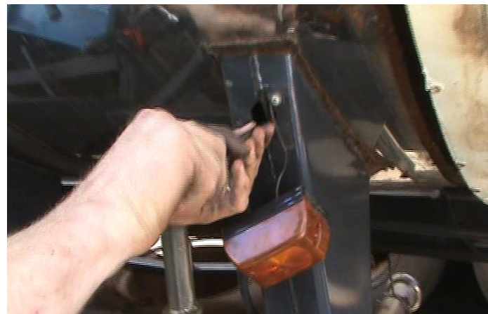
Botão escondido que aciona a abertura do fundo falso
