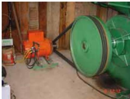
Acoplamento por polias e correias turbina gerador
