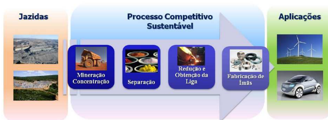
Figura 2.7 Exemplo de um processo produtivo de terras-raras
