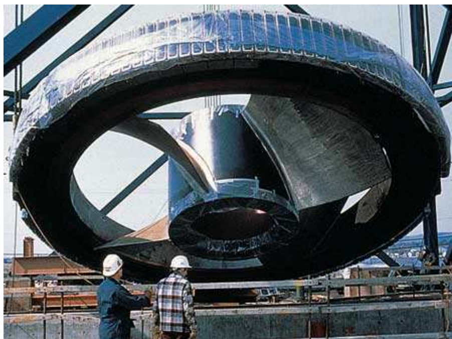
Figura 4 – Estrutura tipo Straflo , que inclui a turbina hidráulica e o rotor do gerador elétrico.
